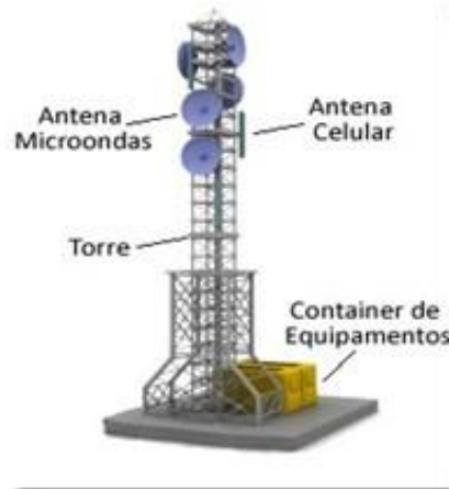
SBA: Site e Torre - Oi: Antenas e Container (ERB)
